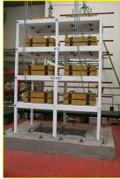
Telaio senza controventi
