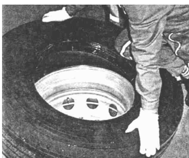
Montaggio del primo tallone
