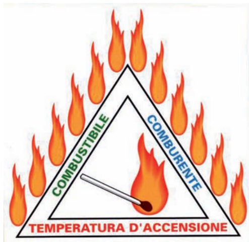
11.1 - Triangolo di fuoco: rappresentazione simbolica delle condizioni necessarie per la combustione
