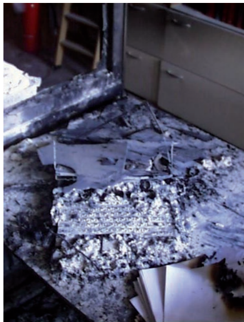
11.20 - PC portatile incendiato durante la ricarica
