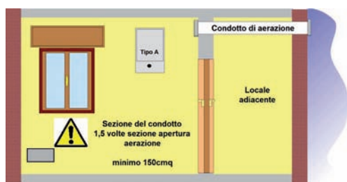
8.17 - Condotto di aerazione
