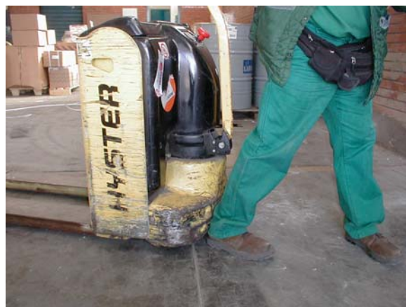
Carrello con fascia di protezione per i piedi
