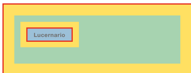
Figura 24 zone di pericolo su un tetto piano
