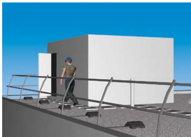
Figura 17 tetto piano con protezione montata ai bordi del tetto
