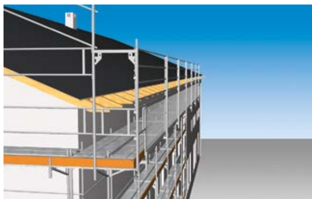
Figura 13 soluzione con mensola interna sul ponteggio, che impedisce la caduta di persone tra il ponteggio e la parete esterna della costruzione.
