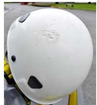
**3** Va sostituito anche questo casco con un difetto visibile.
