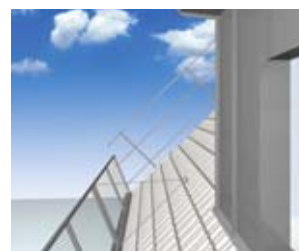
4 Parete di ritenuta sul tetto fissa e protezione lato frontone su tetto esistente
