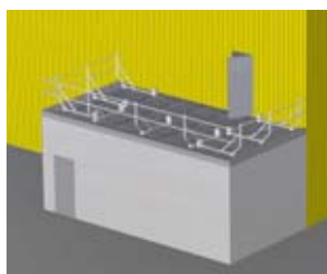
2 Tetto piano con protezione laterale provvisoria
