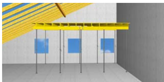
2 Ponteggio di ritenuta in fase di allestimento. Questo deve essere prolungato fino a proteggere l'intera zona a rischio di caduta.
