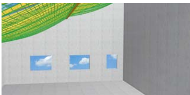
1 Rete di sicurezza installata direttamente al di sotto della travatura del tetto
