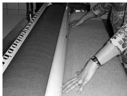
Fig. 3: mangano con protezione per dita e mani. La macchina si arresta non appena si entra in contatto con il dispositivo di protezione.
