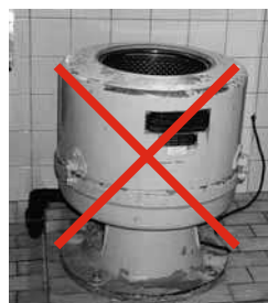
Fig. 4: le centrifughe senza blocco del coperchio vanno messe fuori servizio.
