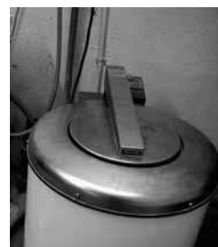
Fig. 4: le centrifughe senza blocco del coperchio vanno messe fuori servizio.
