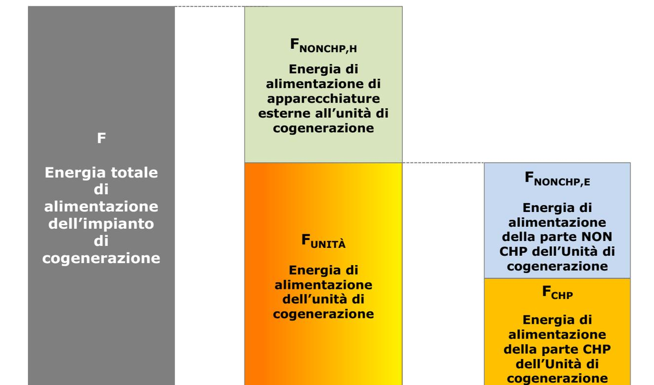
Figura 14 - Componenti dell'Energia totale di alimentazione dell'impianto
