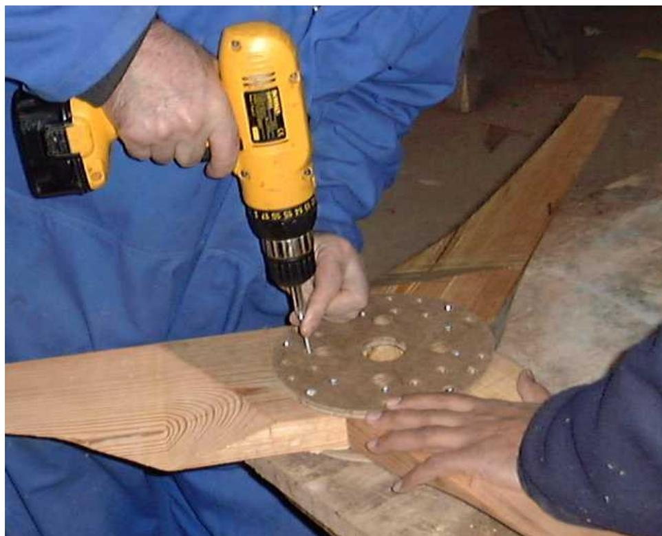
Fig. 3.5: Costruzione artigianale di un rotore minieolico
