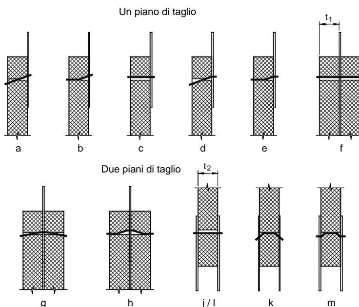
Figura B.18- Modi di rottura per unioni acciaio-legno.
