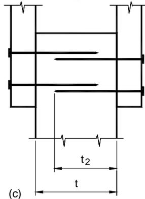
Figura B.20– Possibilità di sovrapposizione per chiodi infissi senza preforatura
