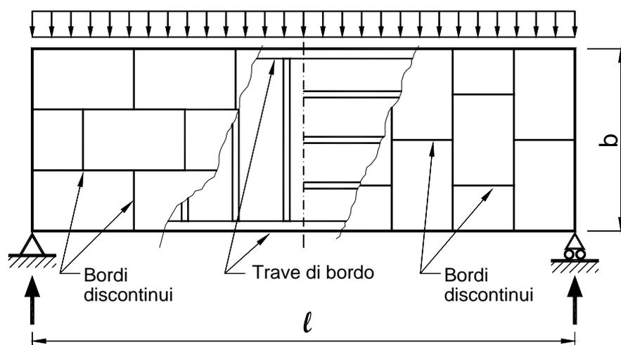
Figura B.10- Esempio di carico sul diaframma e di disposizione sfalsata dei pannelli.
