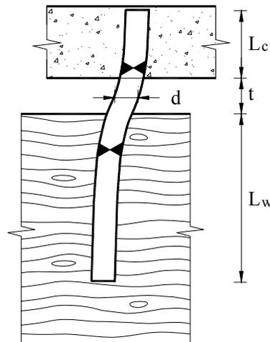
**Figura B.33 Connessione realizzata con spinotti a gambo cilindrico**
