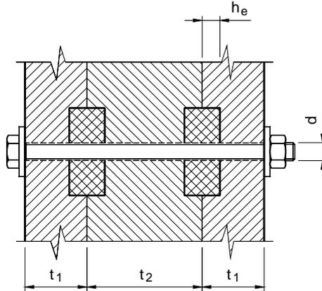
**Figura B.26- Parametri geometrici dell'unione**
