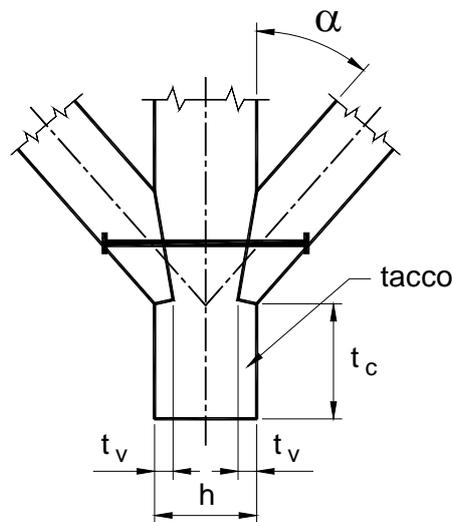
**Figura B.14- Unione a dente simmetrico**
