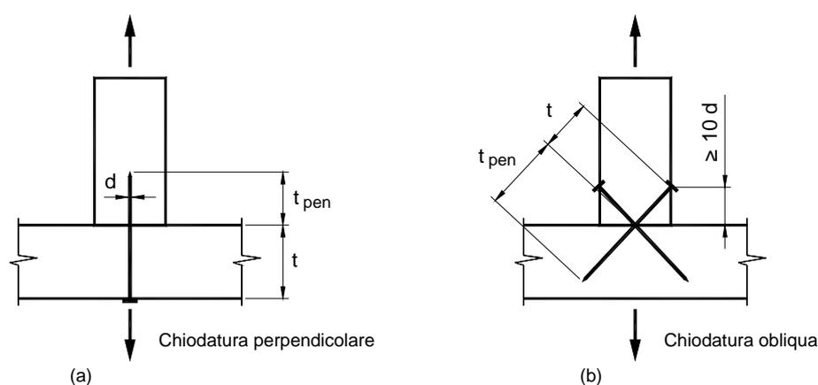
Figura B.23 – Disposizione della chiodatura perpendicolare ed obliqua
