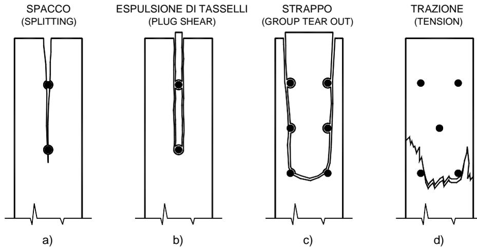
**Figura B.16– Tipi di fratture fragili in unioni a gambo cilindrico**
