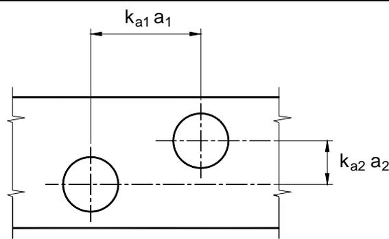
**Figura B.27- Distanze ridotte tra i mezzi di unione**
