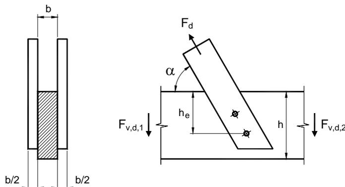
Figura B.12– Resistenza a spacco per unioni sollecitate a trazioni trasversali
