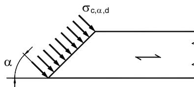
**Figura B.3– Tensioni inclinate rispetto alla fibratura**
