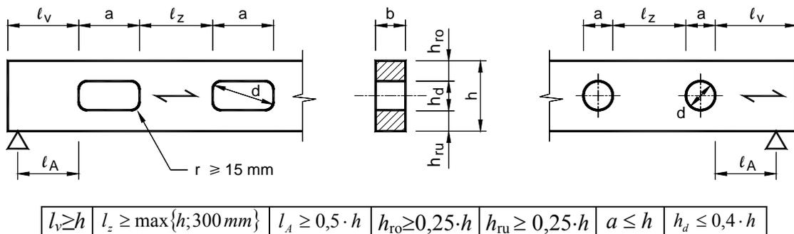
Figura B.8-Dimensione e posizione dei fori rettangolari e circolari
