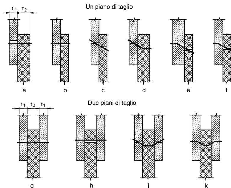
**Figura B.17- Meccanismi di rottura per unioni legno-legno e pannelli-legno**
