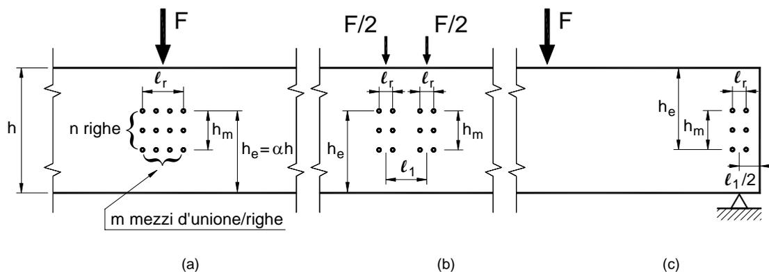
Figura B.13— Parametri della connessione
