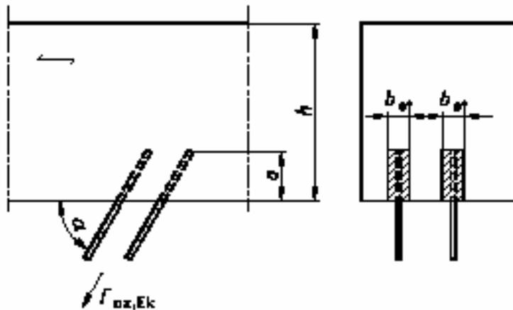
**Figura B.30- Larghezza efficace  $b_{ef}$  e sforzo di ancoraggio agenti sotto un angolo  $\alpha$**
