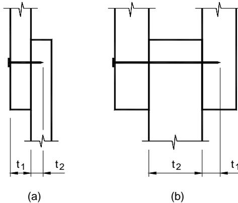
Figura B.19– Definizione degli spessori  $t_1$  e  $t_2$
