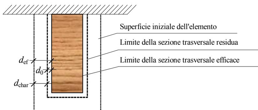
**Figura B.34–Sezione trasversale di un elemento ligneo parzialmente carbonizzato**
