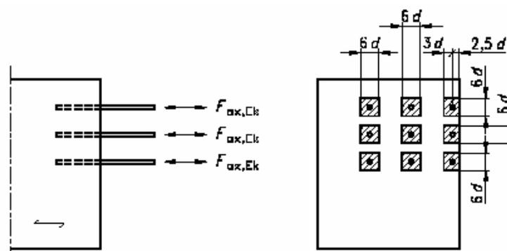
**Figura B.28- Area efficace con sforzi di ancoraggio paralleli alla fibratura.**
