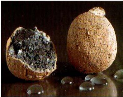
L'argilla espansa è un materiale edilizio che si ottiene dalla cottura di sferette d'argilla in forni rotativi a 1200° C.
