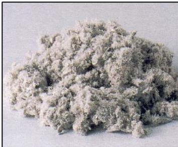
La fibra di cellulosa (carta) è una preziosa materia prima, e si adatta particolarmente bene come isolante termico per via della struttura dei suoi pori in grado di rinchiudere grandi quantità d'aria, riducendo le perdite di calore. Originalmente il legno ha una struttura a fibre parallele, la quale viene modificata durante la trasformazione in carta, le fibre si orientano in tutti i sensi, realizzando così una porosità maggiore e di conseguenza un buon potere isolante.
