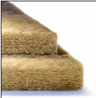
La fibra di lino è ottenuta da una materia prima rigenerabile, la pianta del lino da coltivazione biologica, con lavorazione non inquinante e scarsa richiesta energetica in fase di produzione e applicazione.
