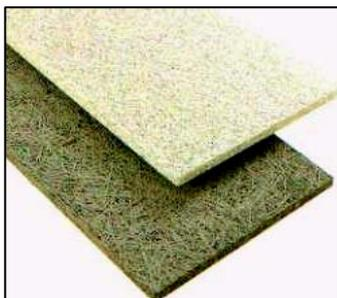
Le fibre di legno, macinate e sfibrate mediante opportuni trattamenti meccanici, vengono impregnate con magnesite (ossido di magnesio) estratta da cave, o cemento Portland per realizzarne la mineralizzazione che apporta alle fibre una notevole coesione e compattezza strutturale.
