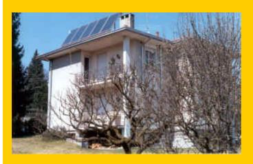
I collettori solari (11,5 m² di superficie) sono montati sul tetto della casa bifamiliare situata a Comignago, in provincia di Novara. Durante l'inverno l'impianto solare fornisce acqua calda sanitaria e riscaldamento al proprietario che occupa l'appartamento del primo piano. In estate anche la seconda famiglia usufruisce dell'acqua calda sanitaria. A causa dell'assenza del proprietario durante il giorno il riscaldamento è attivo in modalità 'solar only' tramite radiatori convenzionali.
