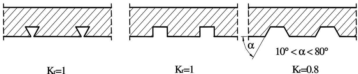
Figura 7.3 - Valori del coefficiente di forma delle lamiere grecate”.
