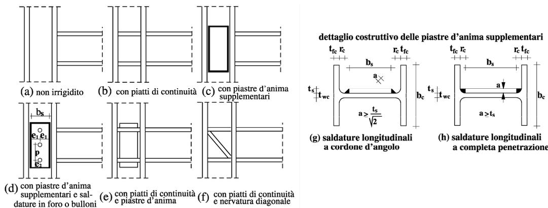
Figura 6.2. Dettagli costruttivi di pannelli nodali irrigiditi.
