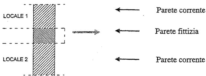
20. **ponte termico** è per ponte termico la discontinuità di isolamento termico che si può verificare in corrispondenza agli innesti di elementi strutturali (solai e pareti verticali o pareti verticali tra loro).
