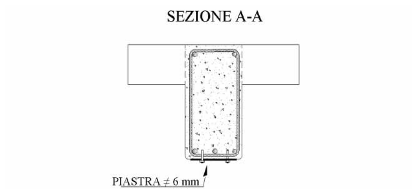
Figura 84. Vista in sezione di cui alla Figura 83
