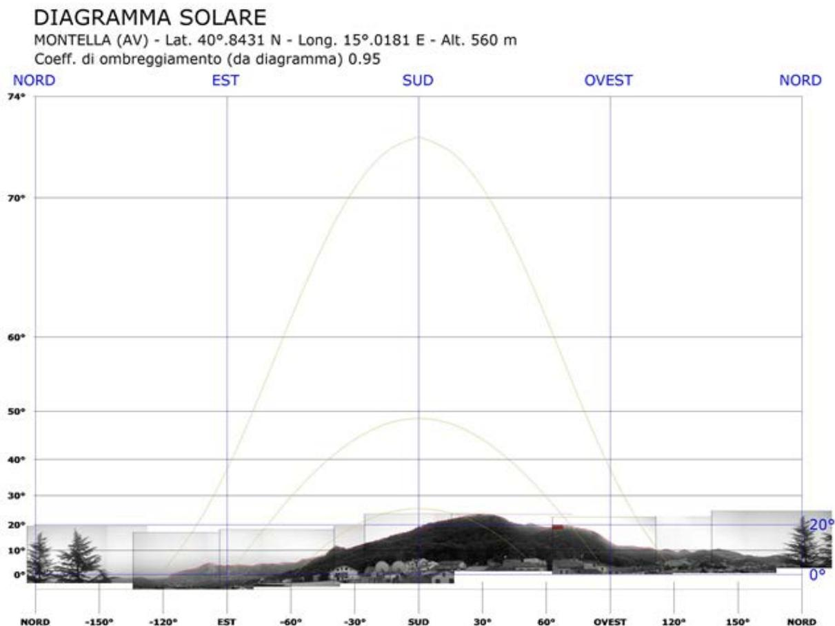
Fig. 2: Diagramma solare
