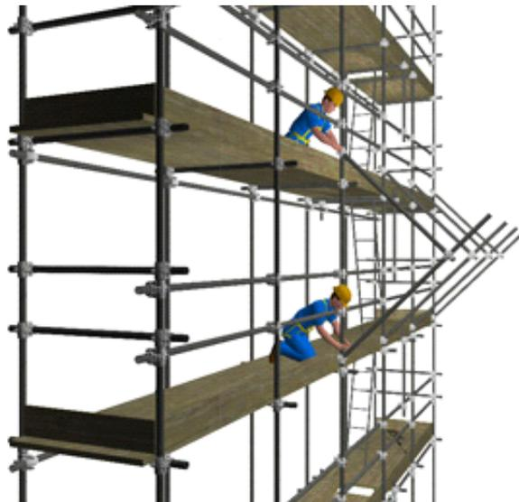
Step C: Un lavoratore posizionato sull'impalcato provvisto di parapetto e tavola fermapiede posizionerà le prime file di tavole fissando i meccanismi di blocco.
