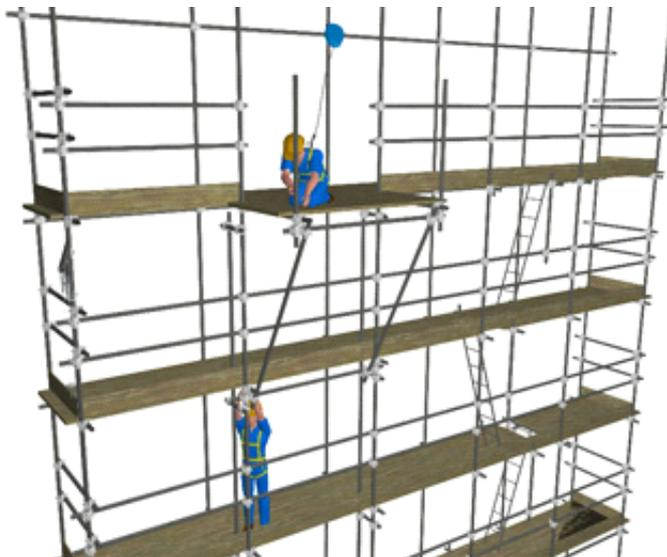
Step D: Il lavoratore in quota, terminerà il montaggio della piazzola montando i correnti parapetto e la tavola fermapiède.
