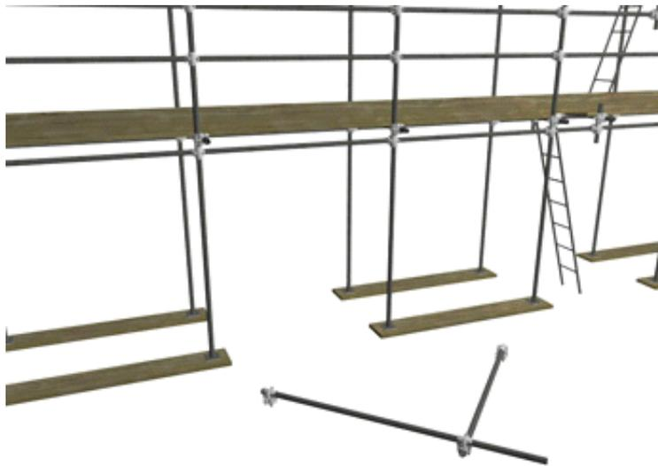
Step B: Due lavoratori posizionati su due impalcati successivi, completi di parapetti e tavola fermapiede, monteranno la struttura portante della mantovana. Gli elementi della mantovana saranno sollevati in quota mediante "passamano" o argano.
