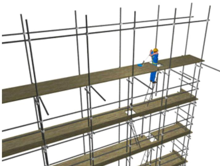
Step B: I lavoratori posizionati al piano inferiore a quello dello sbalzo, dopo aver utilizzato l'argano per tirare in quota gli elementi dello sbalzo, mediante "passamano", li passeranno al lavoratore in quota. Il lavoratore in quota sistemerà quindi le tavole dello sbalzo sommitale fissando i meccanismi di blocco.
