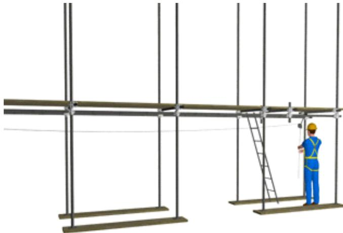
Step C: Il lavoratore in quota, dotato di imbracatura e posizionato sulla scala d'accesso, aggancerà il cordino di trattenuta alla linea di ancoraggio e si porterà sull'impalcato da montare.
