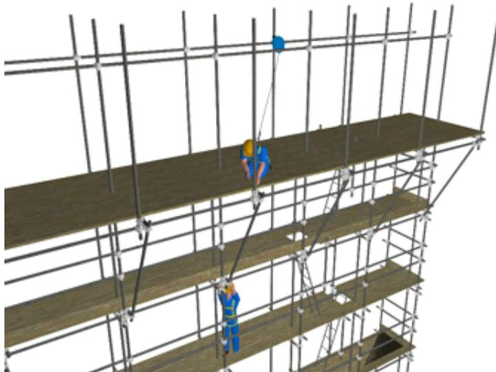
Step D: Il lavoratore in quota, terminerà il montaggio dello sbalzo montando i correnti parapetto e la tavola fermapiède.
