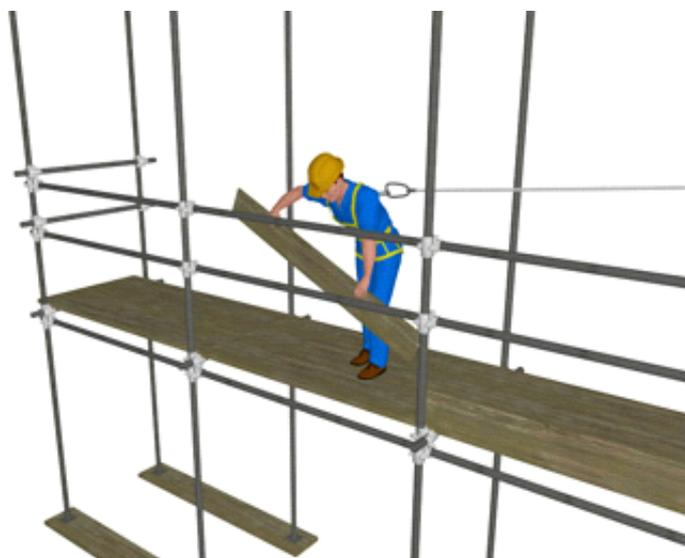
Step B: Il lavoratore in quota, mediante "passamano", passerà ai lavoratori a terra gli elementi del ponteggio smontati.
