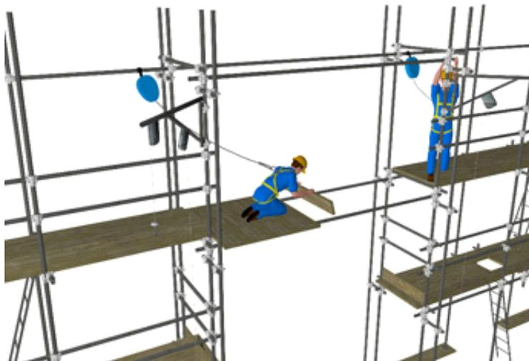
Step D: Il lavoratore posizionato sulla mezzeria del varco, aiutato anche dall'altro lavoratore, monterà gli elementi del passo nel seguente ordine: montanti di mezzeria, traversi di mezzeria, parapetti, diagonali e ancoraggi di mezzeria. I due lavoratori, poi, posizionati nuovamente sulle estremità del varco monteranno gli ancoraggi di estremità del varco.
